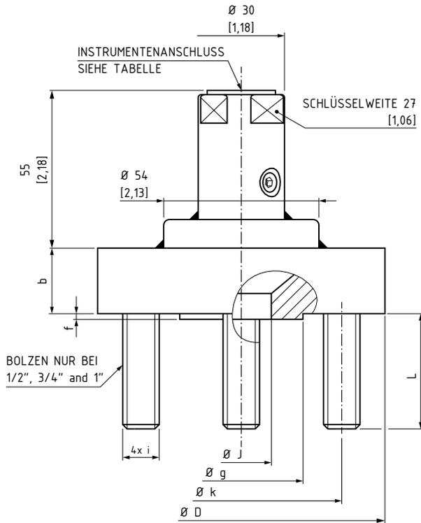
**DRUCKMITTLER TYP 503 MIT SPÜLBOHRUNG**
