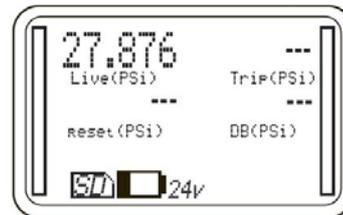
Im Schaltestestmodus zeigt das Display anfänglich den aktuellen Druck (den Druck, der zurzeit angewendet wird) und die Maßeinheit. Der Auslösepunkt des Schalters, der Rücksetzpunkt und die Totzone (DB) sind leer und werden durch „---“ dargestellt.
