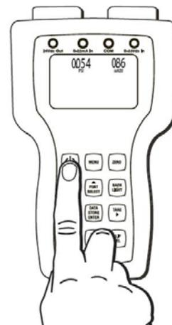
Nach dem Einschalten wird auf dem LCD-Display kurz die Kalibratormodellnummer, die Seriennummer, Eigentümerinformationen angezeigt sowie, ob das Modell eigensicher ist oder nicht. Wenn Druck-
